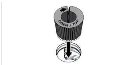
Slika 7.7 Umetanje filtra s aktivnim ugljenom u otvor odvoda
